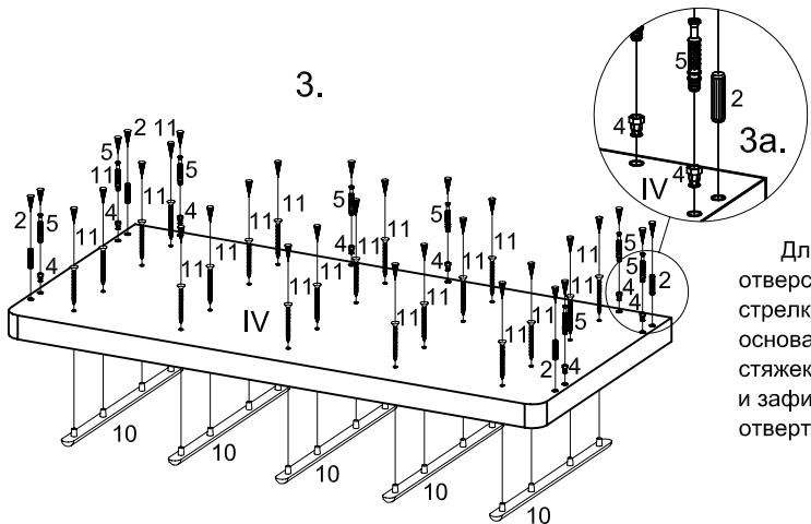
Для установки корпуса полки багажной на основание, вставить в отверстия в стенках боковых (I) корпуса полки стяжки-эксцентрики (3) стрелкой в направлении отверстий на торцах. В глухие отверстия Ø8мм в основании вбить шканты (2), а в отверстия Ø5мм вкрутить дюбеля (1) стяжек-эксцентриков до упора в обод. Установить корпус полки на основание и зафиксировать, поворачивая стяжки-эксцентрики (3) в стенках боковых (I) отверткой по часовой стрелке (рис. 4).
