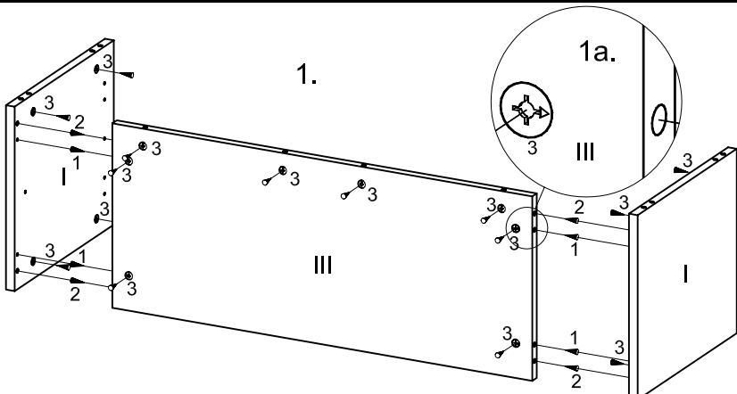
Сборка корпуса полки багажной показана примере корпуса ГБК-86. Сборка корпуса ГБК-82 производится аналогичным образом.
