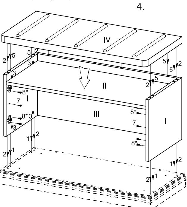
В стенки боковые (I) корпуса тумбы вкрутить дюбеля (7) эксцентриковых стяжек (рис. 4).
