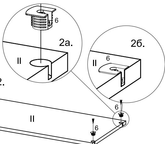
Положить полку центральную (II) на ровную поверхность, отверстиями вверх и легким постукиванием запрессовать стяжки эксцентриковые (6) (рис. 2, 2а и 2б). Во избежании повреждения стяжки, для запрессовки рекомендуется использовать резиновый молоток, в случае его отсутствия, запрессовку производить через фальш-панель или брускок.
