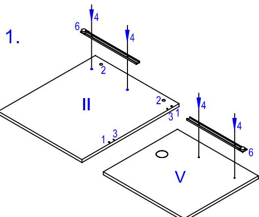
Определить с какой стороны будет находиться системный блок. При сборке руководствоваться приложенной схемой расположения отверстий. Положить необходимыми отверстиями вверх: выдвижную панель (без отверстий), среднюю панель, боковину.
