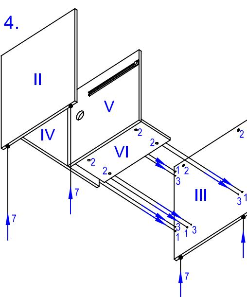
Соединить среднюю панель с передней панелью и нижней полкой. Стянуть каркас, поворачивая стяжки-эксцентриков (2) отверткой по часовой стрелке (см.рис.3). Присоединить к каркасу боковины и затянуть отверткой стяжки-эксцентрики (2) на передней панели и нижней полке (см.рис.4).
