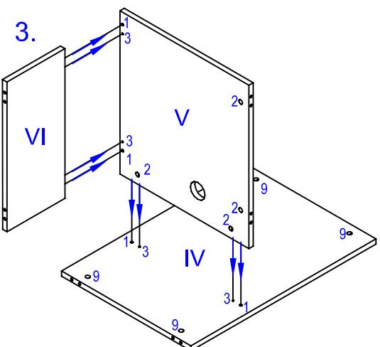
Положить столешницу отверстиями вверх. Забить в столешницу шканты (1) и вкрутить дюбеля стяжек-эксцентриков (3). Надеть столешницу на каркас и затянуть отверткой стяжки-эксцентрики на боковинах и средней панели. Закрыть торцы стяжек-эксцентриков декоративными заглушками (см.рис.5).
