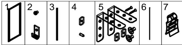
Модуль (1) с фиксатором нижним и винтом М5х6 с полукруглой головкой, шлиц (2). Стойка вертикальная (3) с фиксатором и винтом установочным (4). Комплект крепежа "Модуль-стол" (5). Заглушка профильная (6). Скоба пружинная (7). Количество элементов определяется дизайн-проектом.
